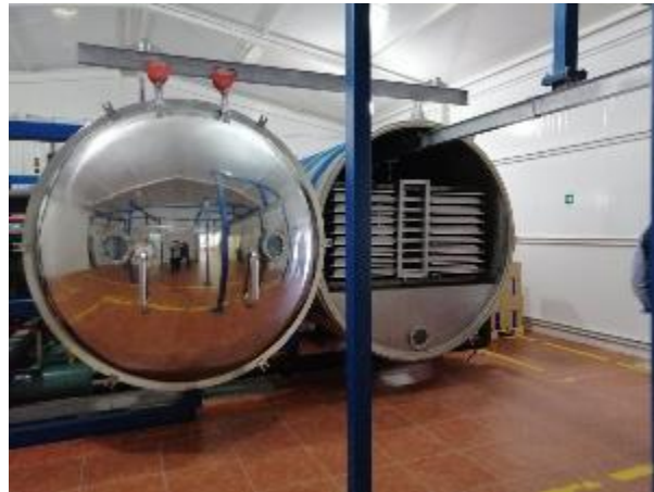
Figura 15 Liofilizador, Empresa Lankorganic, Lanco
