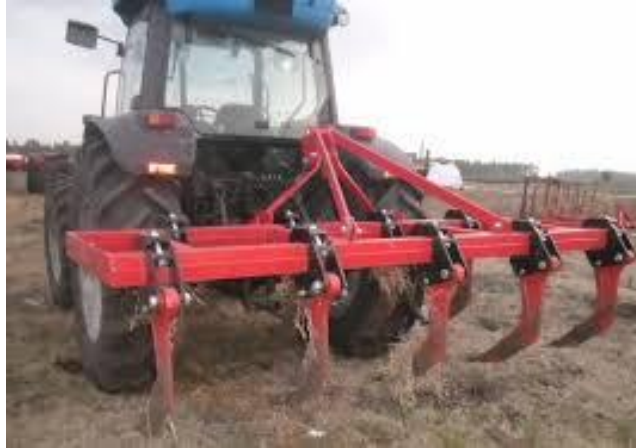
Arado subsolador recomendado para preparación de suelos
